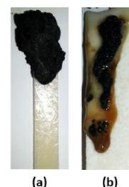
Figure 3 : Evolution du comportement du FR-PLA au test LOI, avant (a) et après 6 jours de vieillissement (b).
